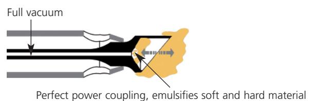
**Fig. 5: Efficient fragment aspiration**
